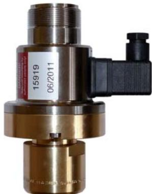
Устройство электромагнитного пуска приводятся в действие от установки пожарной сигнализации. Устройство представляет собой соленоид, шток которого при срабатывании воздействует на обратный клапан ЗПУ. В верхней части привода расположено резьбовое соединение для установки устройства ручного пуска
