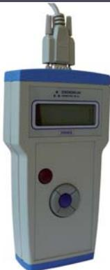
Прибор калибровки подключается к запорно-пусковому устройству МГПУ ИНЕЙ через специальный разъем.
