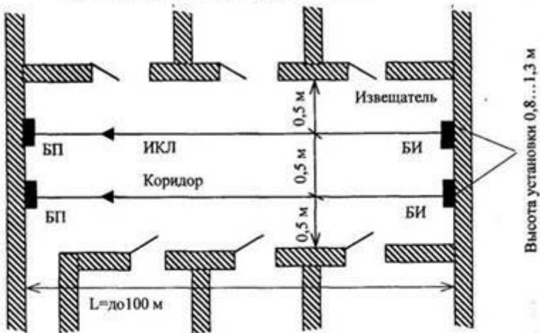
Вариант 1. Блокировка коридора извещателями активными линейными оптико-электронными
