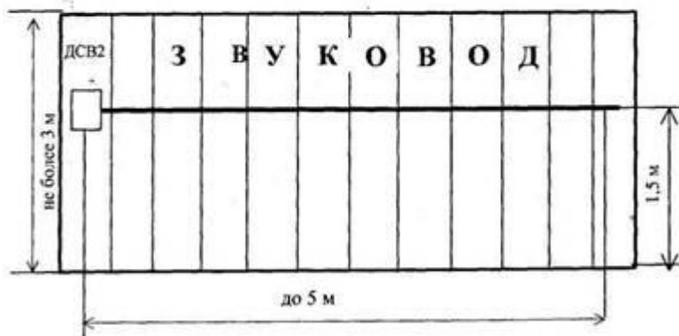
Вариант 3. Блокировка стен, потолка и пола на пролом
