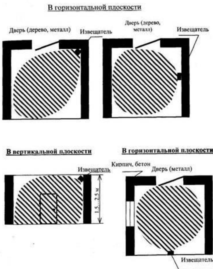
Вариант 7. Блокировка двери на открывание и проникновение извещателем объемным радиоволновым (комбинированным)
