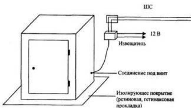
Вариант 1. Блокировка сейфа извещателем емкостным
