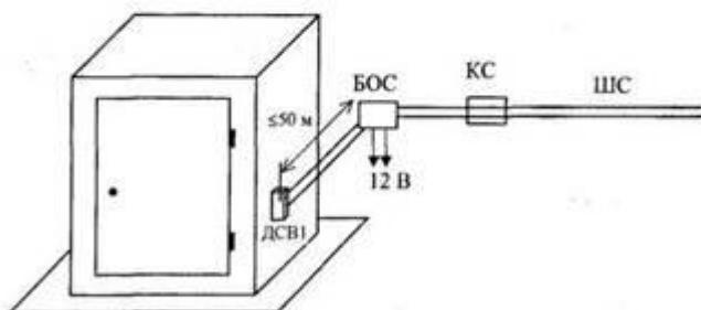
БОС-блок приема и обработки сигнала
