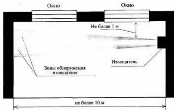
Вариант 3. Блокировка окон на проникновение извещателем поверхностным оптико-электронным с зоной обнаружения типа "занавес"
