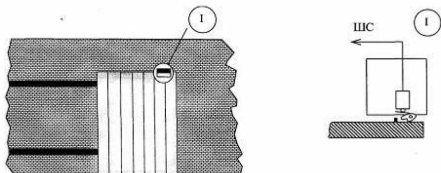
Вариант 2. Блокировка раздвижных ворот выключателем конечным
