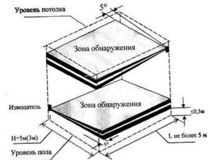
Вариант 2. Блокировка стен, потолка и пола на проникновение
