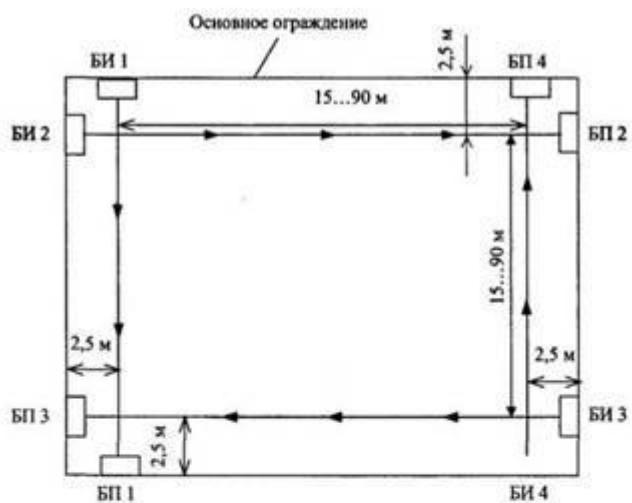
Вариант 5. Блокировка замкнутого основного ограждения извещателями линейными радиоволновыми
