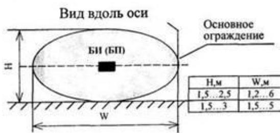
Вариант 4. Блокировка основного ограждения извещателем линейным радиоволновым
