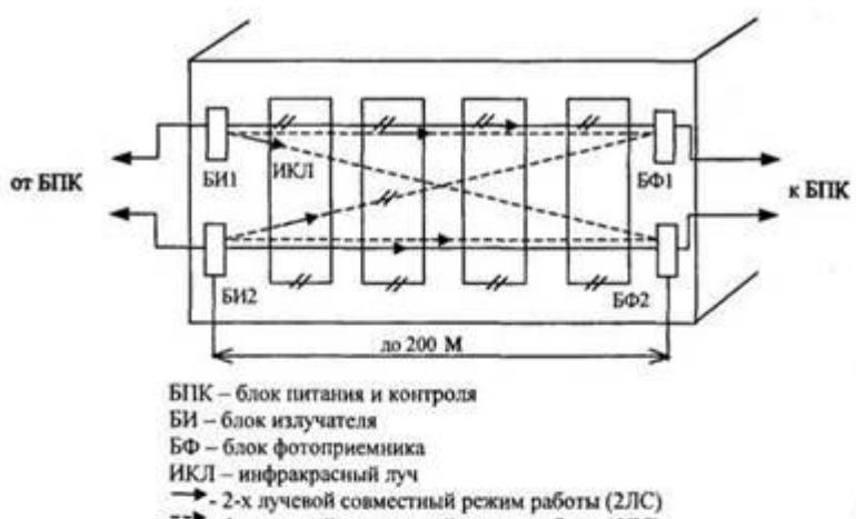
Вариант 2. Блокировка периметра здания извещателем активным оптико-электронным
