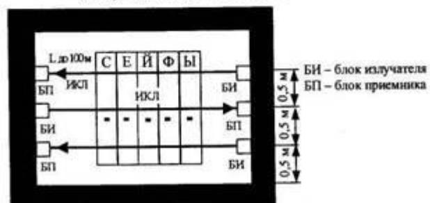
Вариант 5. Блокировка сейфов (предметов) извещателями активными оптико-электронными
