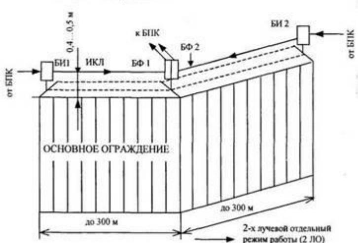
Вариант 3. Блокировка основного ограждения извещателем активным оптико-электронным
