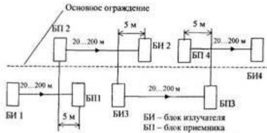
Вариант 1. Блокировка основного ограждения извещателями линейными радиоволновыми
