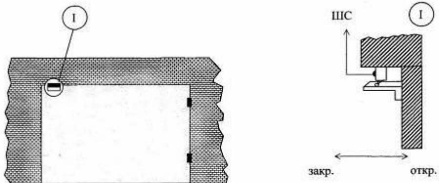
Вариант 1. Блокировка распашных ворот выключателем конечным
