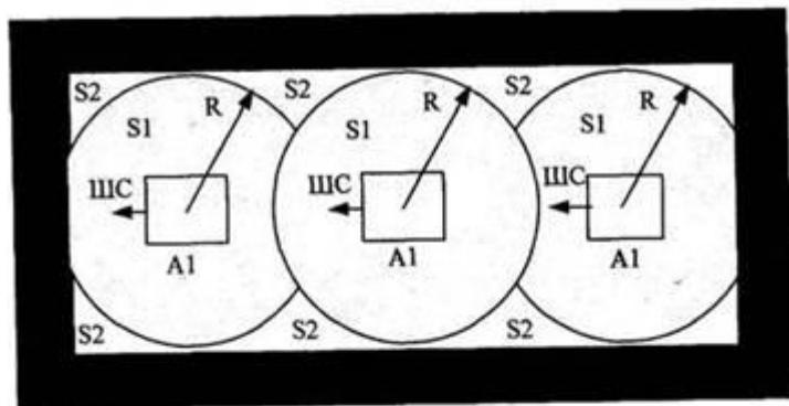
Размещение извещателя для охраны монолитного пола, потолка,
