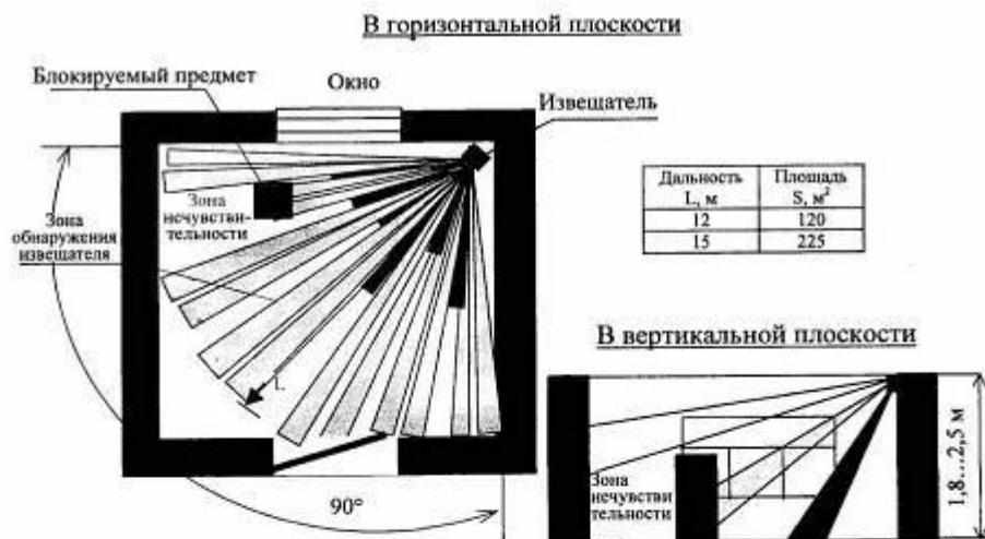
Вариант 7. Одновременная блокировка объема и отдельных предметов оптико-электронным извещателем
