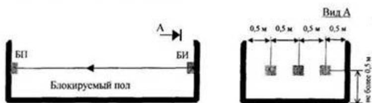
Вариант 5. Блокировка стен, потолка и пола на проникновение извещателями активными линейными оптико-электронными
